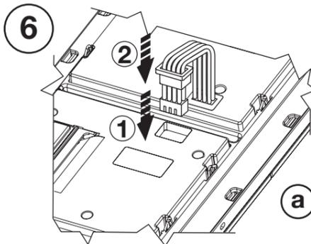
☞ Sull'ultimo modulo assicurarsi di proteggere il connettore OUT tramite il tappino fornito a corredo.
