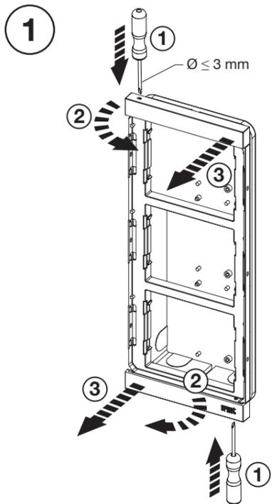
Per lo smontaggio delle testate utilizzare un cacciavite piatto a punta 0.
