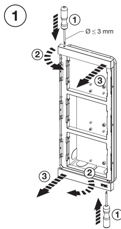
Per lo smontaggio delle testate utilizzare un cacciavite piatto a punta 0.
