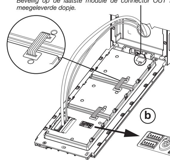
**Per la connessione tra moduli appartenenti a telai affiancati, occorre utilizzare il cavo fornito a corredo del telaio.**
