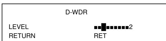
En sélectionnant NIVEAU et en appuyant vers la droite ou vers la gauche, il est possible de réduire l'écart de luminosité entre les zones claires et les zones sombres.
