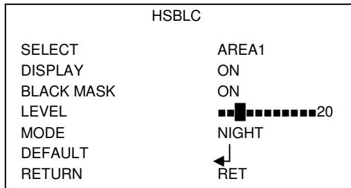
Le aree disponibili all'interno del menu SELECT sono 4, per le quali è possibile attivare la BLACK MASK (MASCH NERA) definendo posizione e dimensione (DISPLAY), il livello di luminosità (da 0 a 255) e il MODO (ALL DAY o NOTTE, per il quale è possibile regolare l'AGC LEVEL). Con il comando DEFAULT si possono ripristinare i valori precedenti.
