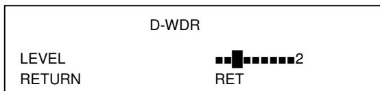
Durch Auswahl von LEVEL und durch Drücken nach rechts oder links können die Helligkeitsunterschiede zwischen den dunklen und hellen Zonen verringert werden.
