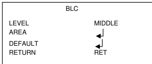
Le opzioni per la voce LEVEL sono: medio, alto, basso. In AREA è possibile configurare dimensione e posizione, oppure con DEFAULT ripristinare i valori precedenti.
