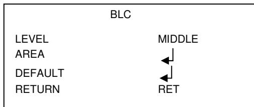
Les réglages de l'option LEVEL sont les suivants : moyen, haut et bas. Sur AREA, il est possible de configurer dimensions et position ; l'option DEFAULT permet quant à elle de rétablir les valeurs précédentes.
