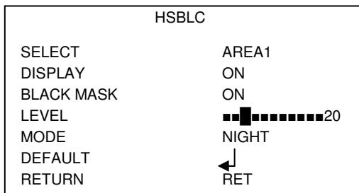
El menú SELECT tiene 4 áreas, para las que podrá definir la posición y tamaño (DISPLAY), su nivel de brillo (0 a 255) y su modo MODE (ALL DAY y NIGHT, para el que puede ajustarse el nivel de AGC LEVEL) y activar BLACK MASK. Puede utilizar el comando DEFAULT para restablecer los valores anteriores.
