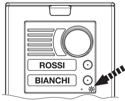
Funzione "feedback di chiamata": al momento della chiamata da un qualsiasi modulo con tasti, viene emesso dal posto esterno un segnale visivo che testimonia l'effettivo inoltro della chiamata (led lampeggiante).
