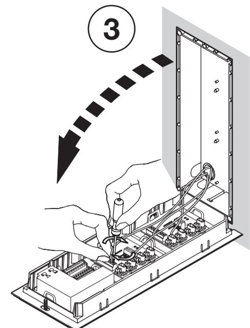
Ribalteare il telaio ed effettuare i cablaggi.
