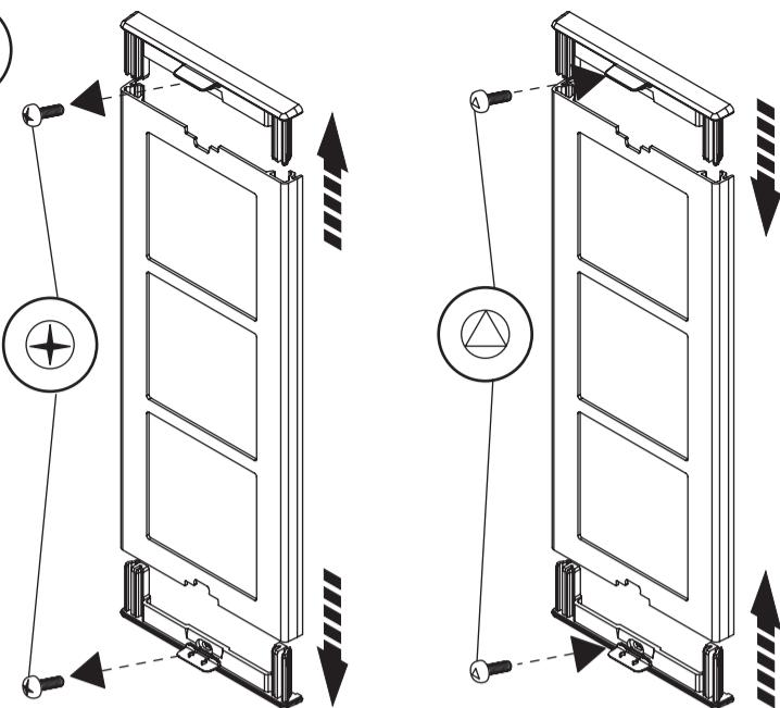
Se si desidera è possibile sostituire le viti a testa croce con viti antifurto (fornite a corredo dell'unità di ripresa)
