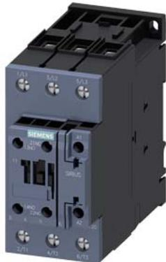
contator de potência, CA-3e/CA-3, 80 A, 37 kW / 400 V, de 3 polos, CA 200 V, 50 Hz / 200-220 V, 60 Hz, contatos auxiliares: 1 NA + 1 NF, conexão parafusada, tamanho da estrutura: S2
