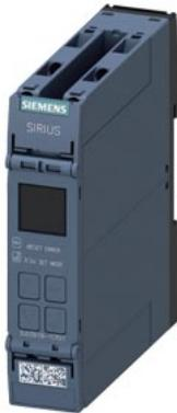
relé de monitoramento ajustável digitalmente monitoramento da queda de fase, sequência de fases, assimetria, frequência, sobretensão e subtensão com correção da sequência de fases 3x 90-690 V CA, 15-70 Hz 2 contatos inversores conexão parafusada SIL 1/PL c
