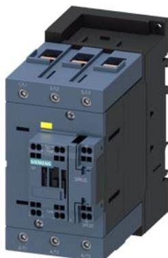
contator de potência, CA-3e/CA-3, 80 A, 37 kW / 400 V, de 3 polos, CA/CC 175-280 V, 50/60 Hz, com varistor integrado, contatos auxiliares: 1 NF, circuito principal de corrente: conexão parafusada, circuito auxiliar e circuito de comando: terminal de mola, tamanho da estrutura: S3, F-CLP-IN
