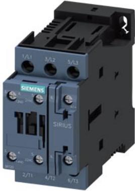
contator ferroviário, CA-3e/CA-3, 32 A, 15 kW / 400 V, de 3 polos, 110 V CC, 0,7-1,25\* US, unidade propulsora eletrônica, com varistor integrado, contatos auxiliares: 1 NA + 1 NF, conexão parafusada, tamanho da estrutura: S0
