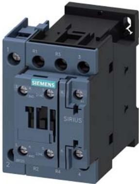
contator de potência, CA-3, 25 A, 11 kW / 400 V, de 4 polos, 400 V CA, 50 Hz, contatos principais: 2 NA + 2 NF, contatos auxiliares: 1 NA + 1 NF, conexão parafusada, tamanho da estrutura: S0
