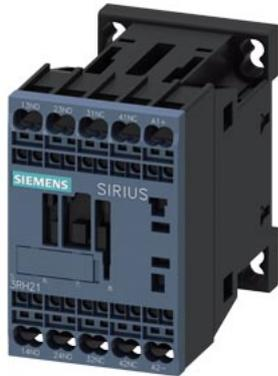
contator auxiliar para trilho, 2 NA + 2 NF, 24-34 V CC, 0,7-1,25\* US, com varistor integrado, terminal de mola, tamanho da estrutura S00
