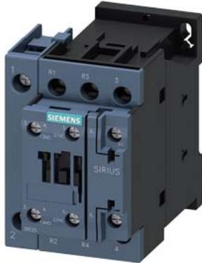
contator de potência, CA-3, 25 A, 11 kW / 400 V, de 4 polos, 230 V CA, 50/60 Hz, contatos principais: 2 NA + 2 NF, contatos auxiliares: 1 NA + 1 NF, conexão parafusada, tamanho da estrutura: S0
