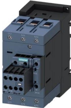
contator de potência, CA-3e/CA-3, 95 A, 45 kW / 400 V, de 3 polos, CA/CC 83-155 V, 50/60 Hz, com varistor integrado, contatos auxiliares: 2 NA + 2 NF, conexão parafusada, tamanho da estrutura: S3, interruptor auxiliar removível
