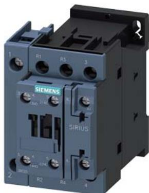
contator de potência, CA-3, 25 A, 11 kW / 400 V, de 4 polos, CA 42 V, 50/60 Hz, contatos principais: 2 NA + 2 NF, contatos auxiliares: 1 NA + 1 NF, conexão parafusada, tamanho da estrutura: S0
