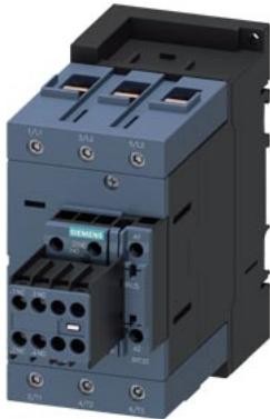
contator de potência, CA-3e/CA-3, 110 A, 55 kW / 400 V, de 3 polos, CA/CC 175-280 V, 50/60 Hz, com varistor integrado, contatos auxiliares: 2 NA + 2 NF, conexão parafusada, tamanho da estrutura: S3, interruptor auxiliar removível
