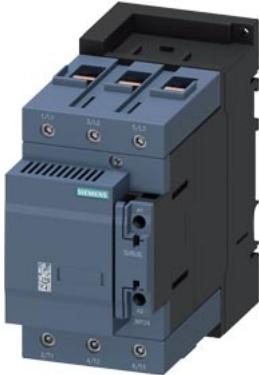
contator para capacitores CA-6b 100 kVAr, / 400 V, de 3 polos, CA/CC 175-280 V, 50/60 Hz, com varistor integrado, contatos auxiliares: 2 NF, conexão parafusada, tamanho da estrutura: S3
