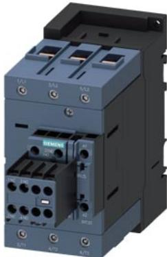
contator de potência, CA-3e/CA-3, 80 A, 37 kW / 400 V, de 3 polos, CA 42 V, 50/60 Hz, contatos auxiliares: 2 NA + 2 NF, conexão parafusada, tamanho da estrutura: S3, interruptor auxiliar removível
