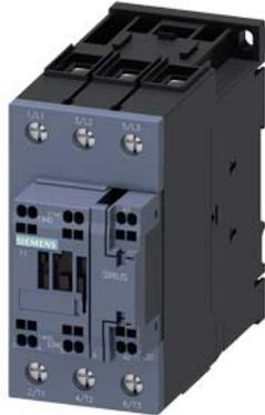
contator de potência, CA-3e/CA-3, 65 A, 30 kW / 400 V, de 3 polos, 230 V CA, 50/60 Hz, com elemento RC inserido, contatos auxiliares: 1 NA + 1 NF, circuito principal de corrente: conexão parafusada, circuito auxiliar e circuito de comando: terminal de mola, tamanho da estrutura: S2,
