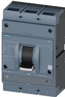
disjuntor 3VA1 IEC Frame 1000 classe da capacidade de interrupção M Icu=55kA @ 415V de 3 polos, proteção de sistemas TM240, ATAM, In=800A proteção contra sobrecarga Ir=560A...800A proteção contra curto-circuito li=5 x In conexão roscada plana disparador de tensão (STL) 220-250V CC, 208-277V CA 2 contatos auxiliares HQ
