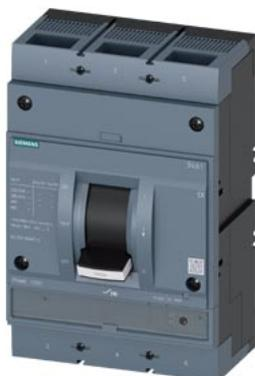
disjuntor 3VA1 IEC Frame 1000 classe da capacidade de interrupção H Icu=70kA @ 415V de 3 polos, proteção do arrancador TM120M, AM, In=800A sem proteção contra sobrecarga proteção contra curto-circuito li=6...12 x In conexão roscada plana
