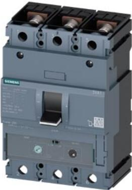
disjuntor 3VA1 IEC Frame 250 classe da capacidade de interrupção M Icu=55kA @ 415V de 3 polos, proteção de sistemas TM240, ATAM, In=160A proteção contra sobrecarga Ir=112A...160A proteção contra curto-círcuito Ii=5...10 x In conexão roscada plana
