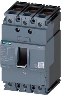
disjuntor 3VA1 IEC Frame 160 classe da capacidade de interrupção N Icu=25kA @ 415V de 3 polos, proteção de sistemas TM210, FTFM, In=160A proteção contra sobrecarga Ir=160A ajustado de modo fixo proteção contra curto-círcuito Ii=10 x In ligação de terminal
