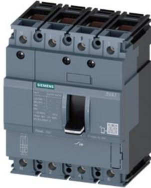
disjuntor 3VA1 IEC Frame 100 classe da capacidade de interrupção S Icu=36kA @ 415V de 4 polos, proteção de sistemas TM210, FTFM, In=63A proteção contra sobrecarga Ir=63A ajustado de modo fixo proteção contra curto-circuito li=10 x In condutor N não protegido ligação de terminal
