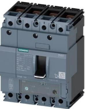
disjuntor 3VA1 IEC Frame 160 classe da capacidade de interrupção H Icu=70kA @ 415V de 4 polos, proteção de sistemas TM240, ATAM, In=125A proteção contra sobrecarga Ir=88A...125A proteção contra curto-círcuito Ii=5...10 x In condutor N não protegido conexão roscada plana
