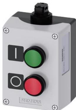
AS-Interface caixa para aparelhos de comando, 22 mm, redondo, material da caixa de plástico; parte superior da caixa cinza, 2 posições de comando de plástico, profundidade para placas, B=botão verde, placa: I, 1NA, conexão de mola, A=botão vermelho, placa: O, 1NF, conexão de mola, fixação no piso, método de penetração em cima, placa incluída
