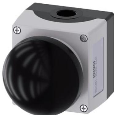
carcaça para aparelhos de comando de 22 mm, redondo, material da caixa de metal, parte superior da caixa cinza, 1 posição de comando de metal, posição de comando central, A = botão tipo cogumelo, preto, tecla com retorno, 1NA, conexão parafusada, fixação no piso
