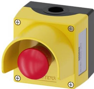
carcaça para aparelhos de comando, 22 mm, redondo, material da caixa de metal, parte superior da caixa amarela, com colar de proteção, 1 posição de comando de metal, A=botão de PARADA DE EMERGÊNCIA em forma de cogumelo, vermelho, 40 mm, desbloqueio por rotação, 1NF, conexão parafusada, fixação no piso, em cima e embaixo para cada 1xM20
