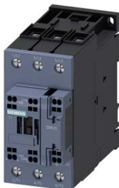
contator de potência, CA-3e/CA-3, 80 A, 37 kW / 400 V, de 3 polos, CA 24 V, 50/60 Hz, contatos auxiliares: 1 NA + 1 NF, circuito principal de corrente: conexão parafusada, circuito auxiliar e circuito de comando: terminal de mola, tamanho da estrutura: S2
