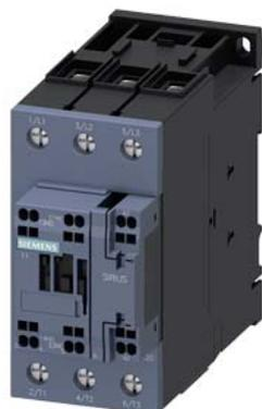
contator de potência, CA-3e/CA-3, 51 A, 22 kW / 400 V, de 3 polos, CA 48 V, 50 Hz, contatos auxiliares: 1 NA + 1 NF, circuito principal de corrente: conexão parafusada, circuito auxiliar e circuito de comando: terminal de mola, tamanho da estrutura: S2
