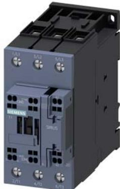
contator de potência, CA-3e/CA-3, 51 A, 22 kW / 400 V, de 3 polos, CA 110 V, 50/60 Hz, contatos auxiliares: 1 NA + 1 NF, circuito principal de corrente: conexão parafusada, circuito auxiliar e circuito de comando: terminal de mola, tamanho da estrutura: S2
