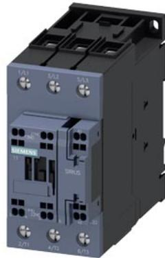
contator de potência, CA-3e/CA-3, 41 A, 18,5 kW / 400 V, de 3 polos, CA/CC 83-155 V, 50/60 Hz, com varistor integrado, contatos auxiliares: 1 NA + 1 NF, circuito principal de corrente: conexão parafusada, circuito auxiliar e circuito de comando: terminal de mola, tamanho da estrutura: S2,
