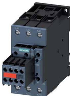
contator de potência, CA-3e/CA-3, 65 A, 30 kW / 400 V, de 3 polos, 230 V CA, 50/60 Hz, com varistor inserido, contatos auxiliares: 2 NA + 2 NF, conexão parafusada, tamanho da estrutura: S2, interruptor auxiliar não removível
