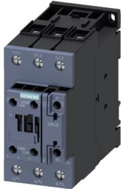
contator de potência, CA-3e/CA-3, 65 A, 30 kW / 400 V, de 3 polos, CA/CC 20-33 V, 50/60 Hz, com varistor integrado, contatos auxiliares: 1 NA + 1 NF, conexão parafusada, tamanho da estrutura: S2
