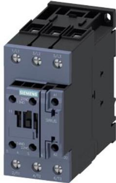
contator de potência, CA-3e/CA-3, 51 A, 22 kW / 400 V, de 3 polos, CA/CC 20-33 V, 50/60 Hz, com varistor integrado, contatos auxiliares: 1 NA + 1 NF, conexão parafusada, tamanho da estrutura: S2
