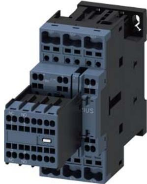
contator de potência, CA-3e/CA-3, 25 A, 11 kW / 400 V, de 3 polos, CA 24 V, 50/60 Hz, contatos auxiliares: 2 NA + 2 NF, terminal de mola, tamanho da estrutura: S0, interruptor auxiliar removível
