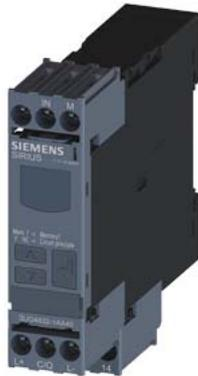
relé de monitoramento digital monitoração da tensão, 22,5 mm para link IO CA/CC 10...600 V sobre e subtensão histerese 0,1 até 300 V tempo de atraso de partida tempo de atraso da ativação 1 contato inversor, conexão parafusada
