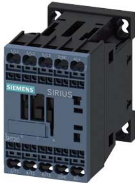
contator de potência, CA-3e/CA-3, 9 A, 4 kW / 400 V, de 3 polos, CC 60 V, contatos auxiliares: 1 NF, terminal de mola, tamanho da estrutura: S00
