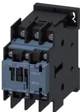
contator de potência, CA-3e/CA-3, 25 A, 11 kW / 400 V, de 3 polos, CA 100 V, 50 Hz / 100-110 V, 60 Hz, contatos auxiliares: 1 NA + 1 NF, conexão de terminal de cabo anular, tamanho da estrutura: S0
