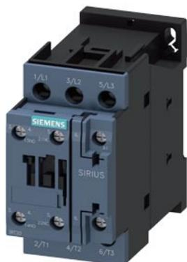
contator de potência, CA-3e/CA-3, 25 A, 11 kW / 400 V, de 3 polos, 400 V CA, 50 Hz / 400-440 V, 60 Hz, contatos auxiliares: 1 NA + 1 NF, conexão parafusada, tamanho da estrutura: S0
