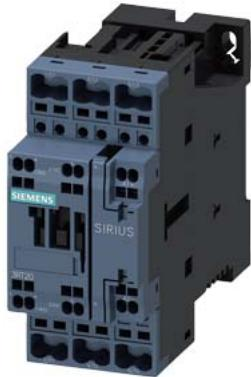
contator de potência, CA-3e/CA-3, 38 A, 18,5 kW / 400 V, de 3 polos, CA/CC 95-130 V, 50/60 Hz, com varistor integrado, contatos auxiliares: 1 NA + 1 NF, terminal de mola, tamanho da estrutura: S0
