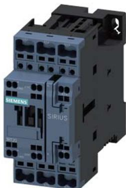
contator de potência, CA-3e/CA-3, 25 A, 11 kW / 400 V, de 3 polos, CA/CC 200-280 V, 50/60 Hz, com varistor integrado, contatos auxiliares: 1 NA + 1 NF, terminal de mola, tamanho da estrutura: S0
