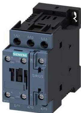
contator de potência, CA-3e/CA-3, 32 A, 15 kW / 400 V, de 3 polos, CA/CC 200-280 V, 50/60 Hz, com varistor integrado, contatos auxiliares: 1 NA + 1 NF, conexão parafusada, tamanho da estrutura: S0
