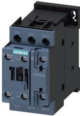
contator de potência, CA-3e/CA-3, 12 A, 5,5 kW / 400 V, de 3 polos, CA 110 V, 50/60 Hz, contatos auxiliares: 1 NA + 1 NF, conexão parafusada, tamanho da estrutura: S0
