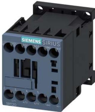
contator de potência, CA-3e/CA-3, 9 A, 4 kW / 400 V, de 3 polos, CC 48 V, contatos auxiliares: 1 NA, conexão parafusada, tamanho da estrutura: S00
