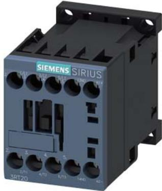
contator de potência, CA-3e/CA-3, 12 A, 5,5 kW / 400 V, de 3 polos, 12 V CC, contatos auxiliares: 1 NA, conexão parafusada, tamanho da estrutura: S00
