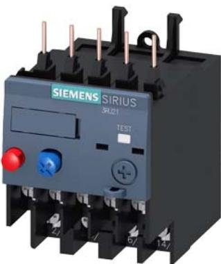
Relé de sobrecarga 1,4...2,0 A térmico para proteção de motor tamanho S00, classe 10 montagem em contator circuito principal: terminal de cabo anular circuito auxiliar: terminal de cabo anular Reset manual automático
