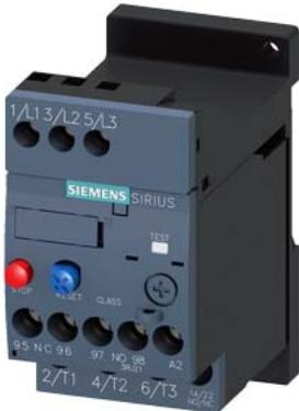
Relé de sobrecarga 7,0...10 A térmico para proteção de motor tamanho S00, classe 10 instalação de funcionamento individual circuito principal: parafuso circuito auxiliar: parafuso Reset manual automático
