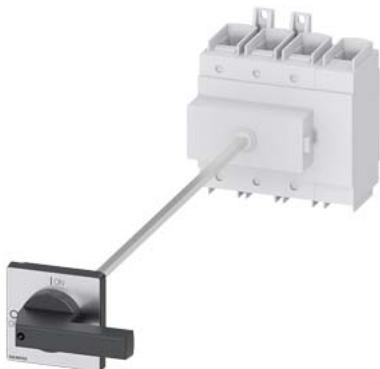
SENTRON, seccionador de corte em carga 3LD, interruptor principal, de 4 polos,  $I_{u}=250A$ , potência de operação/ a CA-23 A a 400V: 132 kW, fixação no piso com acoplamento da porta, acionamento de manípulo, preto, fixação de 4 furos para o manípulo
