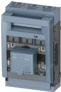
SENTRON, seccionadora-fusível sob carga 3NP1, de 3 polos, NH1, 250 A, para sistema de barramentos coletores 8US 60mm, conexão plana, monitorização dos fusíveis: EFM10 eletrônico, nível da cobertura 32/70mm
