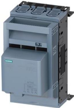
SENTRON, seccionadora-fusível sob carga 3NP1, de 3 polos, NH00, 160 A, para sistema de barramentos coletores 8US 60mm, terminal de caixa, monitorização dos fusíveis: EFM10 eletrônico, nível da cobertura 32/70mm
