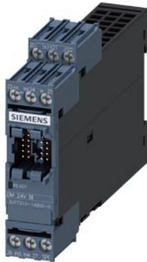
módulo digital, 4 entradas e 2 saídas de relé, tensão de entrada 24 V CC, saídas de relé biestáveis, máx. 2 módulos digitais, para SIMOCODE pro V equipamento de base
